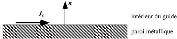
Fig. 8.18 Interface entre l'intérieur du guide et la paroi métallique supportant un courant de surface.
