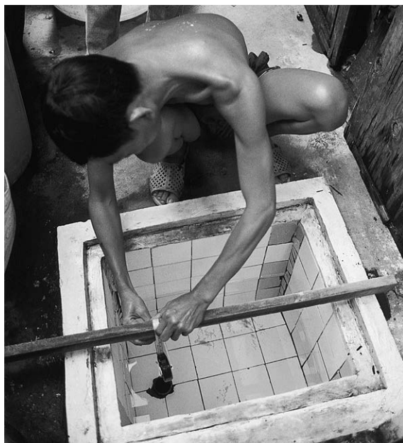
Fig. 6.9 Photo de la mesure du niveau dans un « puits » du quartier 15 (au fond du réservoir on voit l'extrémité du tube noir du forage).
