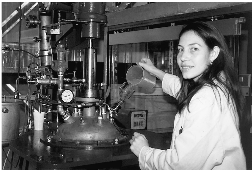
Fig. 3.1 Installation pilote de polymérisation utilisée pour le développement de nouveaux matériaux destinés à la clarification du jus de canne à sucre (DR).
