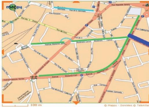
**Fig. 1.5** L'implantation du démonstrateur dans la ville d'Albi. En vert, la partie contrôlée par courant porteur; en bleu (clair et foncé), la partie commandée par radiofréquences (la partie bleu foncé correspond à l'installation supplémentaire après la fin du projet).
