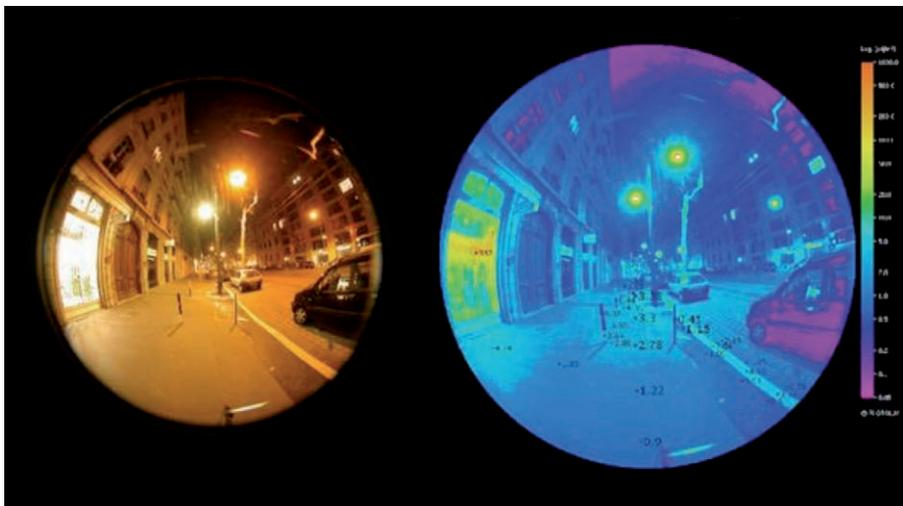
**Fig. 5.4** Des mesures de champs de luminances des potelets et de leur environnement permettent de calculer les contrastes et de les confronter à la détection de ces obstacles.
