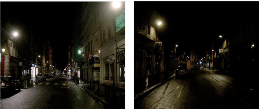
**Fig. 3.7** Eclairages de la rue Edouard-Herriot en diminution partielle et totale.
