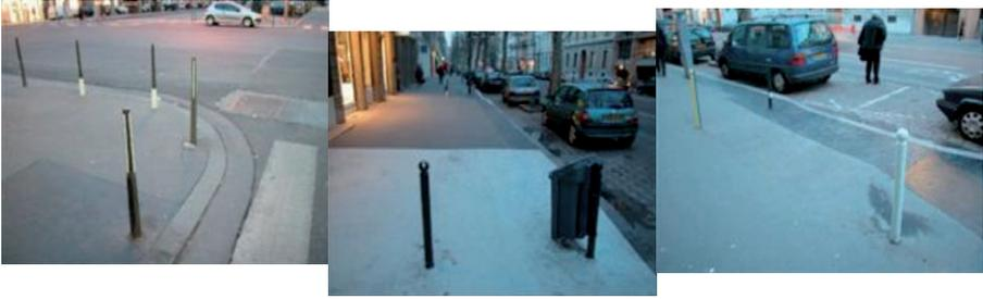
**Fig. 5.6** Diverses solutions permettant de contraster les potelets sont testées; peinture totale ou partielle de la borne, utilisation de la couleur, éclaircissement du trottoir.
