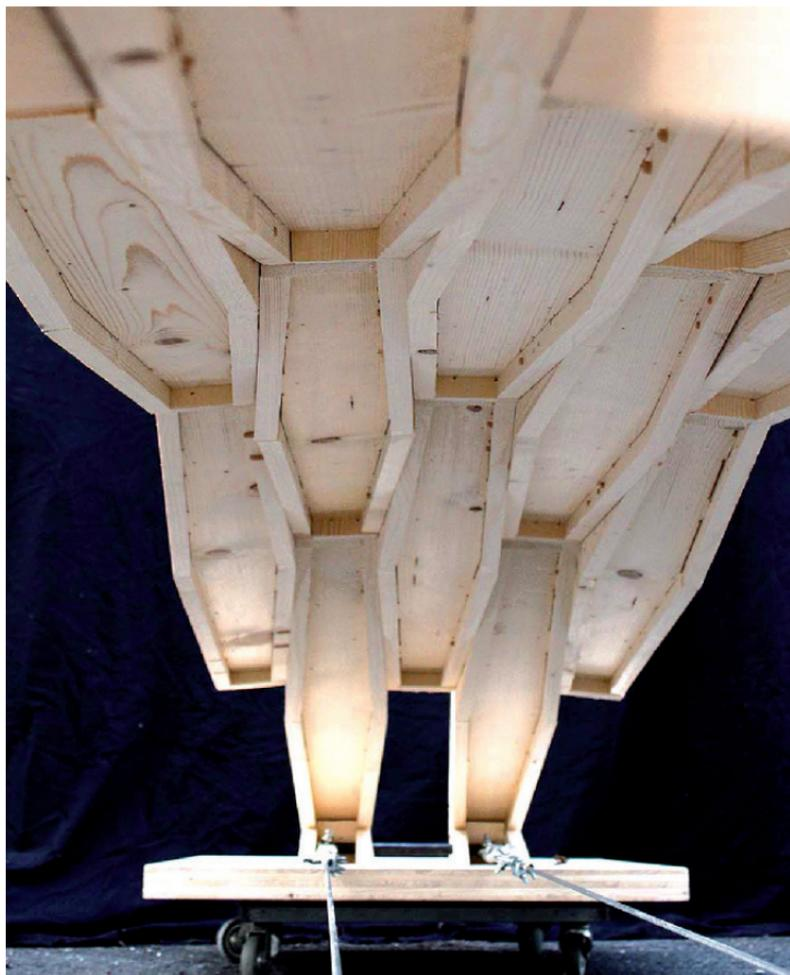
Au total, quinze boîtes sont connectées dans ce prototype qui utilise des planches sciées localement.
