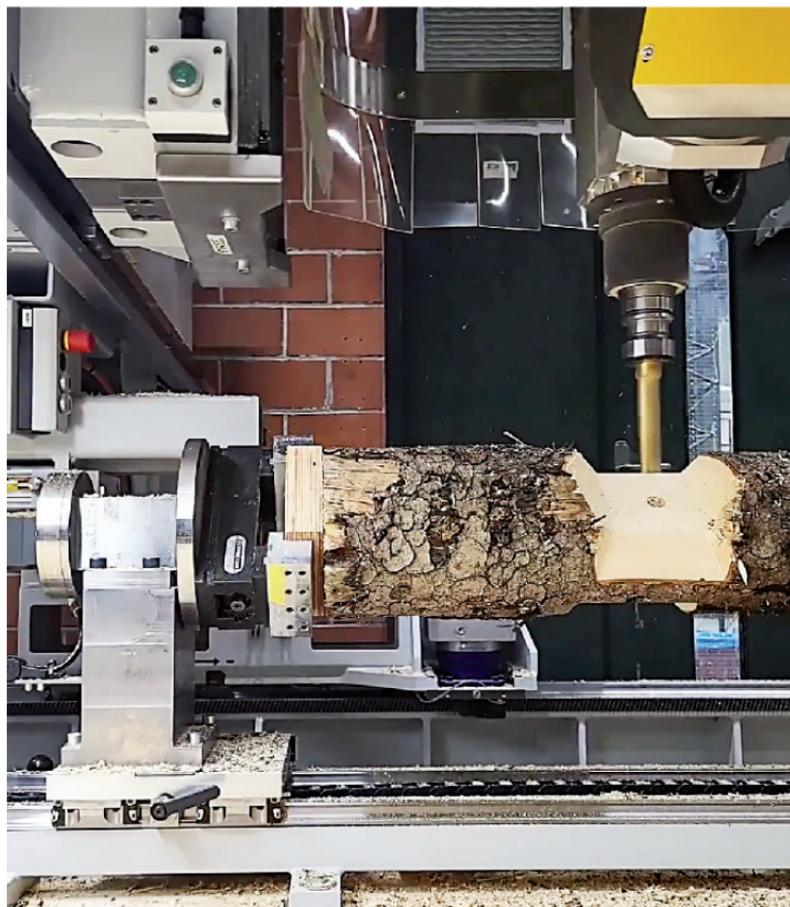
Le processus de découpe est également exécuté avec une CNC 5 axes. Le G-Code est généré avec le logiciel IBOIS raccoon (<https://github.com/ibois-epfl/Raccoon>).
