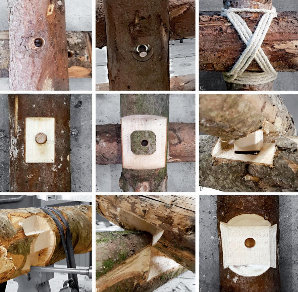
Divers exemples de joints à recouvrement croisé fabriqués robotiquement dans du bois brut (exemple fourni par Petras Vestartas).
