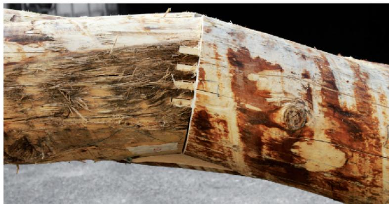
Afin de minimiser l'usinage, du bois brut a été utilisé dans une configuration CNC standard.
