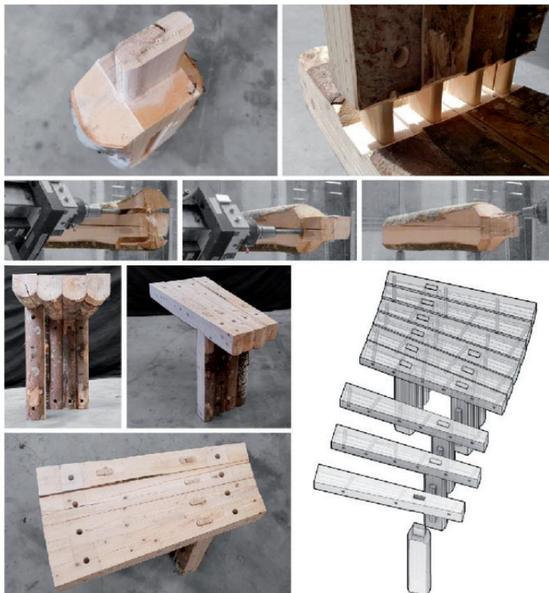
Le bois brut pourrait être utilisé avec des joints qui suivent la direction des fibres, par exemple en tenon-mortaise.
