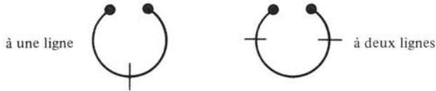
Fig. 3.21 Représentation schématique d'une cavité couplée à une ou plusieurs lignes.
