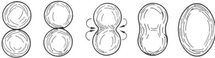
Fig. 4.46 Représentation schématique des étapes successives de la réunion de deux grains par frittage.
