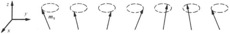
Fig. 3.100 Représentation schématique d'une onde de spin. H est dirigé selon z . m_s = moment magnétique dû au spin.
